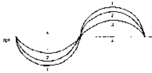
A környezet hőmérsékletingadozásának (1) tompítása a klímatudatos tervezés (2) az épületszerkezetek klímakiégnyelítő hatása (3), valamint a mechanikus fűtés és hűtés (4) eszközeivel. [8.]
